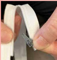
Foto 2a: Tag glideren og sæt den på båndet med tænder. Skub den en lille smule op. Lad som om det er din vinterfrakke, du skal til at tage på. Hold båndet med glider i din venstre hånd.
